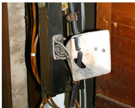
Die selten gewordene Beleuchtungseinrichtung der Leipziger Firma Hoh & Hahne , gebaut nach 1926. Zwei Kohlestäbe erzeugen wie bei einem Schweißgerät einen Lichtbogen.
