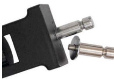
Ein individuell angefertigter Bolzen mit 3/8-Zoll-Fotostativgewinde sitzt auf einem Adapter; eine dicke Unterlegscheibe verhindert, dass Drehknöpfe zu dicht am Arm anliegen.
